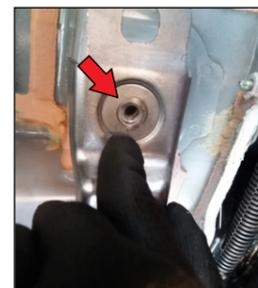
2 - Para modelos até 2018, furar o chassi do veículo utilizando broca Ø11 nos locais previamente definidos pela montadora. A montadora define nas páginas entre D-46 e D-49 do manual do veículo os locais corretos para instalação do engate de reboque. Antes da instalação deve-se ler o manual do veículo e após furar nos locais indicados por "+" na longarina do veículo, conforme ilustração. Os itens "7" não são utilizados neste caso.
