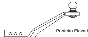
Sempre montar no furo que mantenha a ponteira mais próxima possível do veículo reduzindo a alavanca sobre a estrutura.
